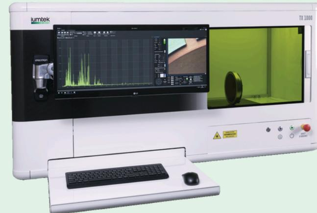
L'analyseur TX 1000 de conception/fabrication iUMTEK est un instrument polyvalent de détection d'éléments chimiques élémentaires qui permet une identification rapide et fiable dans les solides, liquides et milieux gazeux. Cette solution permet un diagnostic en temps réel au cœur des procédés industriels.
